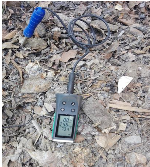
Figure 24 : Thermomètre Skywatch utilisé pour le suivi de la température
